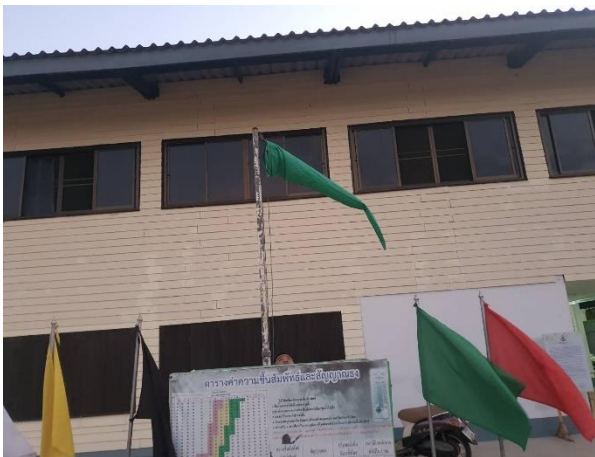
ภาพที่ ๘ แสดงการทดลองใช้นวัตกรรม ชงลุ่มม แสดงทิศทางลม และความเร็วลม ณ บริเวณหน่วยฝึก มทบ.๒๙
