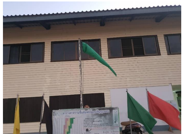
ภาพที่ ๘ แสดงการทดลองใช้นวัตกรรม ชงลุ่มม แสดงทิศทางลม และความเร็วลม ณ บริเวณหน่วยฝึก มทบ.๒๙
